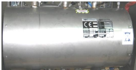
Gerador de Vapor
